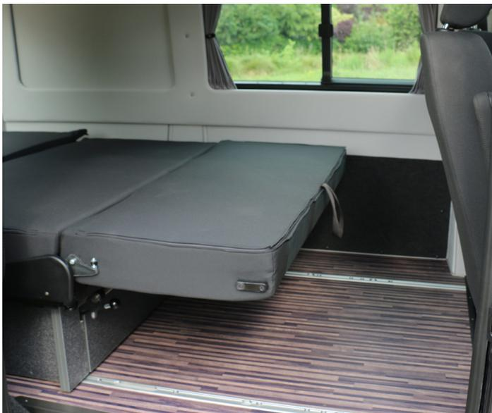
La banquette se transforme en lit pleine largeur en quelques instants. Le lit de grande dimension (205 x 160 cm) est parfaitement plat. En position reculée au maximum, il reste un espace de 40 cm devant la banquette pour une version courte ou de 80 cm sur une version longue.
