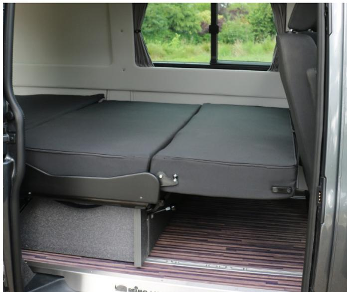
La banquette étant coulissante sur rails, en position lit il est également possible de la positionner en avant ou en arrière. En position avant, il reste un espace de 40 cm derrière la banquette pour une version courte ou de 80 cm pour une version longue.
