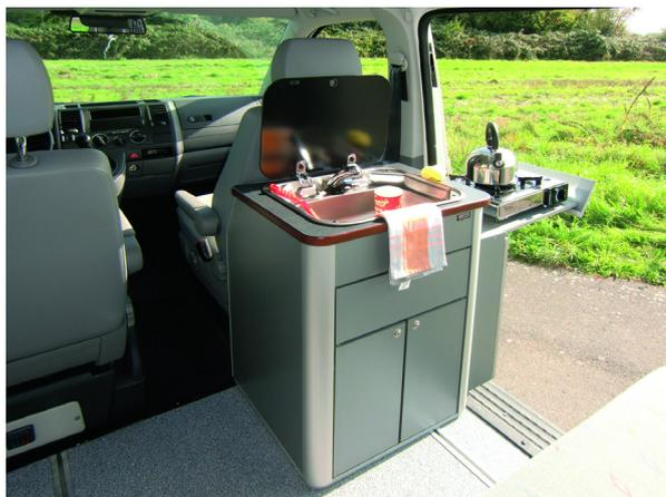
Le meuble de cuisine est amovible et placé derrière le siège passager. Il est équipé d'un évier, de réserves d'eau et d'un réchaud à gaz. En option, une glacière à compression peut être placée derrière le siège conducteur.
