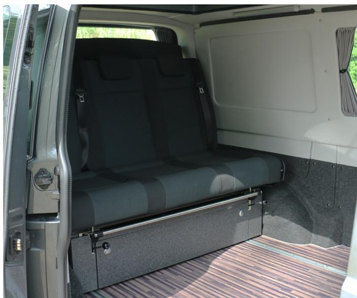
La banquette 3 places coulisse sur l'intégralité du véhicule et en position arrière maximale, permet de bénéficier d'un très grand espace de vie. Les sièges avants étant pivotants, cela permet d'agrandir d'avantage l'espace. La position de la banquette est fixée par des crans situés au niveau des rails, il y a 6 positions sur un véhicule court et 7 sur un véhicule long.
