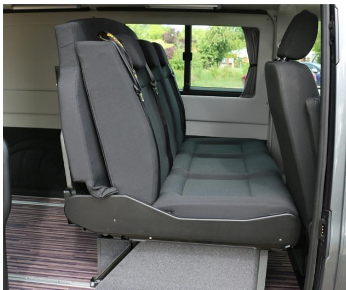
En position avancée au maximum, la banquette vient se coller aux sièges et permet ainsi de bénéficier d'un très grand espace de stockage dans le coffre. La planche arrière du lit vient se plaquer contre l'assise de la banquette afin de libérer un maximum d'espace arrière. La banquette peut également être retirée complètement du véhicule en la sortant par la porte latérale.
