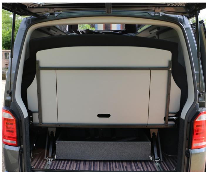
Lorsque la banquette est reculée au maximum, celle-ci vient presque se plaquer contre le hayon, ce qui réduit le coffre au minimum. Le tiroir situé sous la banquette (option) peut être retiré afin de gagner en espace de stockage sous la banquette et de permettre le passage d'objets longs (skis, planches...)
