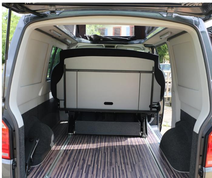
Avancée contre les sièges avants, la banquette offre un grand dégagement arrière qui permet un volume de stockage maximum. En position avancée, la longueur disponible entre le hayon et la banquette est de 1.55m sur une version courte et de 1.95m sur une version longue.
