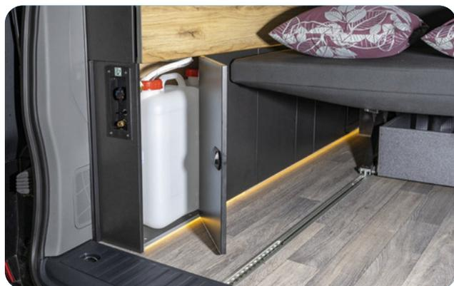
Capacité d'eau propre variable selon vos besoins de 38 à 67 litres. Un réservoir de 27 litres est installé en permanence derrière la cuisine pour les eaux usées (évacuation par le bas). Un raccordement de douche est situé à l'arrière (option).
